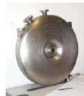
Cavité ré-entrante (Legnaro) 352 MHz - \beta \geq 0,1
