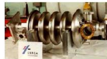
Cavité APT (Los Alamos) 700 MHz - \beta = 0,64
